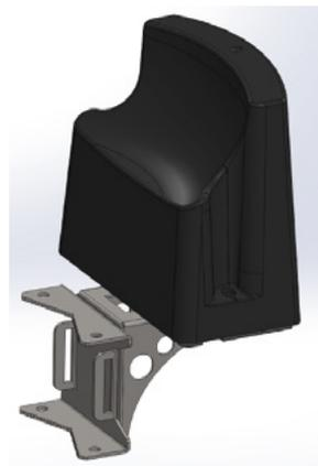
Figure 5 : Option fixation rail DIN
