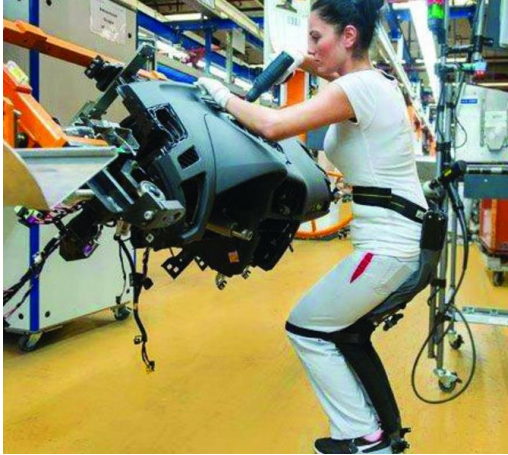
Figure 11 : Exosquelette chez Audi – Noonee
